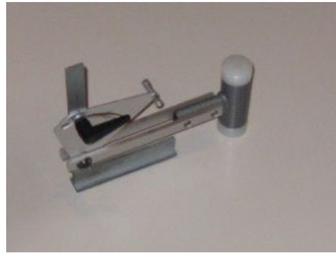
Fig. 2: EMPA pendulum drop hammer
