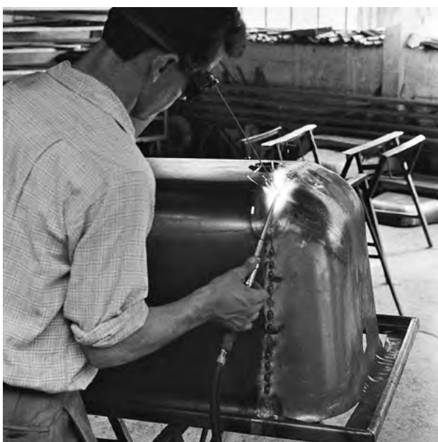
In passato le vasche da bagno erano prodotte saldando insieme tre pezzi grezzi (1948)
