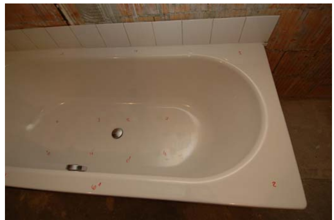
Abb. 2: Badewanne Schmidlin DUETT mit definierten Pendelfallhammer Anschlagpunkten (rot nummeriert) rechts
