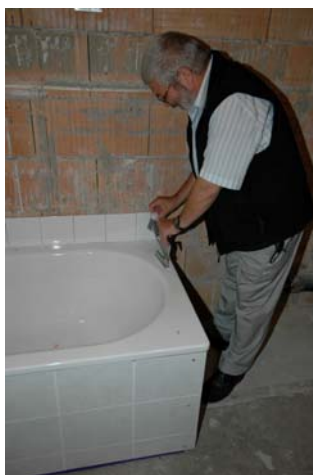
Abb. 3: Benutzungsgeräusch Anregung mittels genormtem EMPA-Pendelfallhammer
