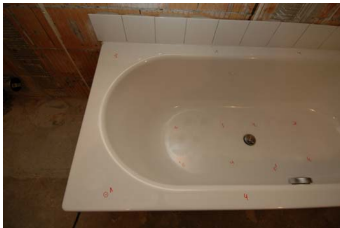
Abb. 1: Badewanne Schmidlin DUETT mit definierten Pendelfallhammer Anschlagpunkten (rot nummeriert) links
